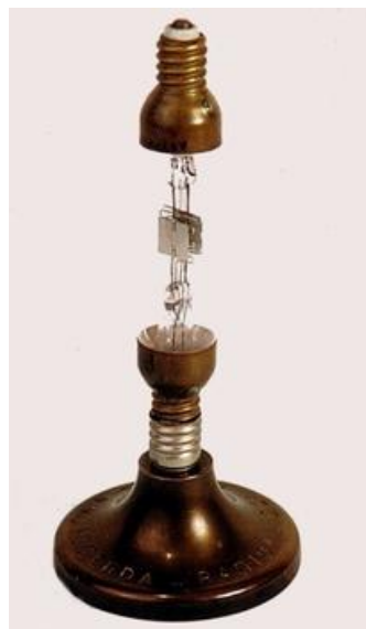
Hiernaast de Idzerda/Philips Ideezet lamp. De aansluitingen bestond uit een E14 lampfitting onder en boven.
